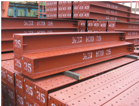
写真1 山留め支保工材 Photo 1 Ordinary strut member
